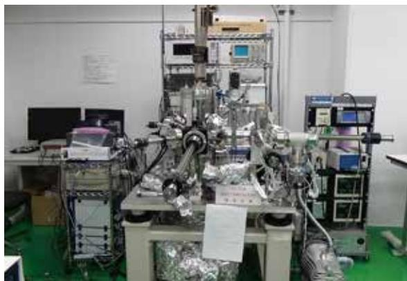
開発した原子分解能走査型非線形誘電率顕微鏡システム
