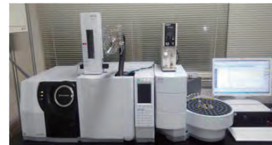
ガスクロマトグラフィー・質量分析装置
