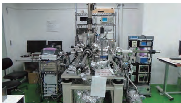
開発した原子分解能走査型非線形誘電率顕微鏡システム
