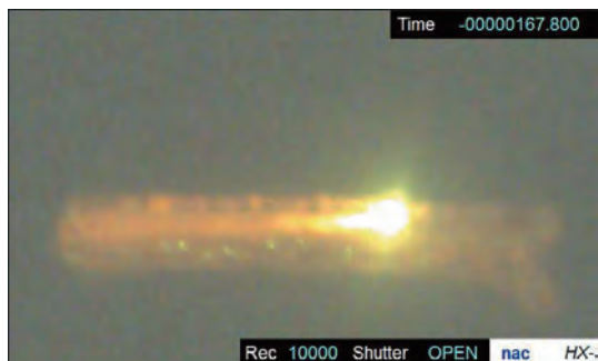
電子ビームによる金属粉末の溶融池形成
