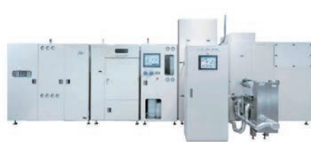
開発した超臨界水熱合成装置(10t/年)
