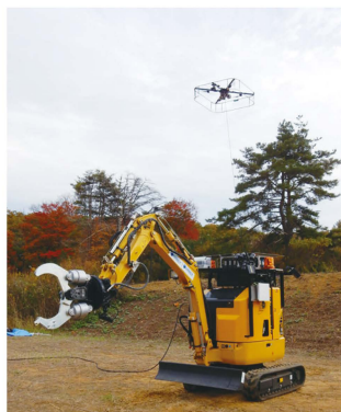
無人建機の 周囲情報を取得する 有線給電飛行ロボット
