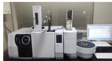
ガスクロマトグラフィー・質量分析装置(GC-MS) 機能性食品の香り成分等の分析が可能
