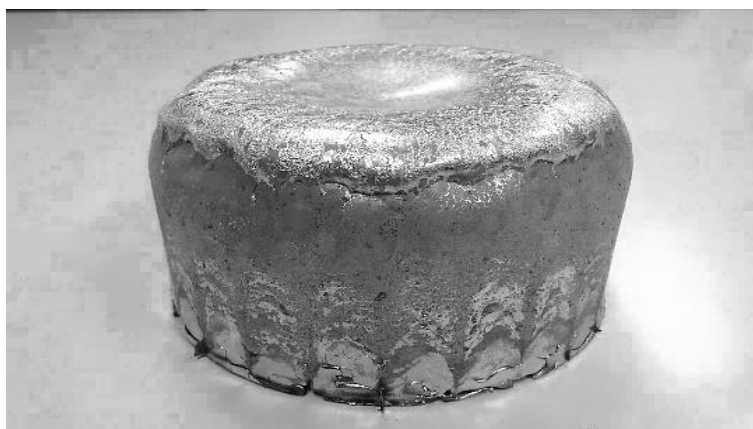
図 超高真空水冷坩堝熔解炉により試作された超高純度鉄基耐熱合金
