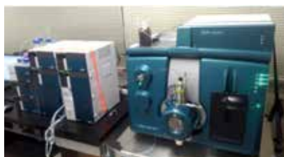
高速液体クロマトグラフィー・ 高感度質量分析装置 機能性食品の微量成分等の 定量分析が可能
