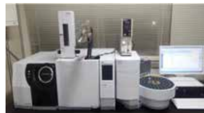
ガスクロマトグラフィー・質量分析装置 メタボローム解析、食品の香気成分等の 分析が可能
