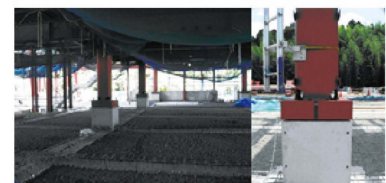
(a)4階建鉄骨ラーメン架構 (b)柱脚機構
