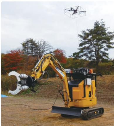
▲ 無人建機の周囲情報を取得する有線給電飛行ロボット
