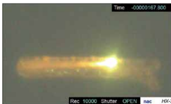
電子ビームによる金属粉末の熔融池形成
