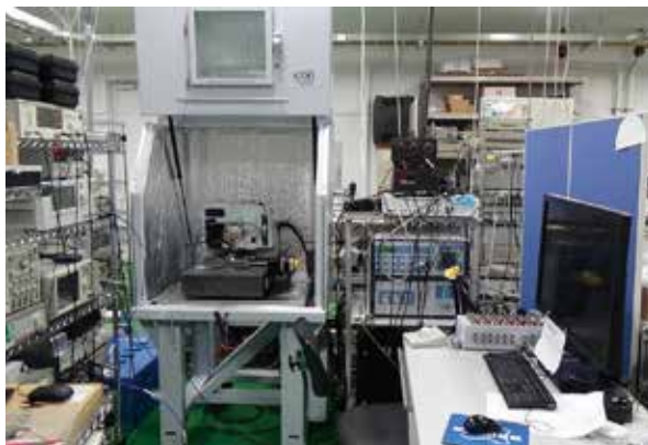
代表者が開発した走査型非線形誘電率顕微鏡システム
