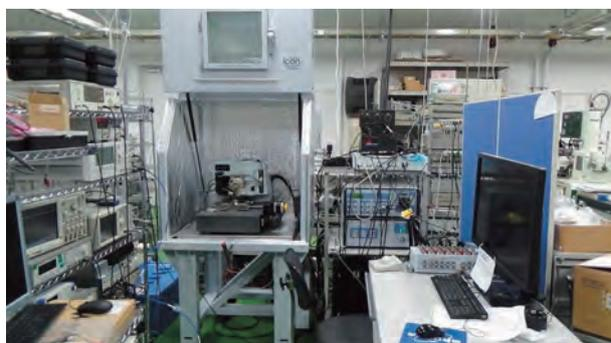
代表者が開発した走査型非線形誘電率顕微鏡システム
