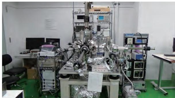
原子分解能走査型非線形誘電率顕微鏡システム
