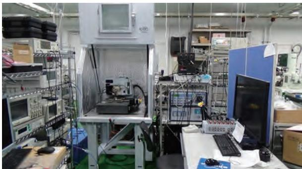
走査型非線形誘電率顕微鏡システム
