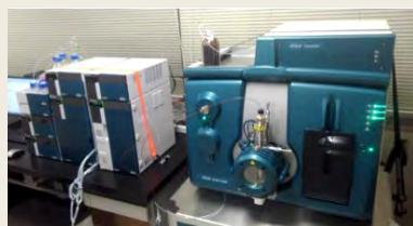
高速液体クロマトグラフィー・質量分析装置 (HPLC-MS/MS)
