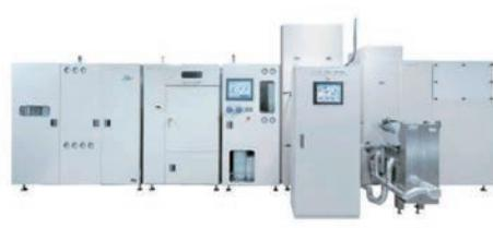
開発した超臨界水熱合成装置(10t/年)
