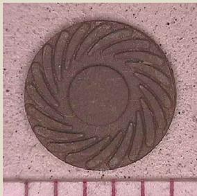
図6. マイクロエネルギー源のためのSiCタービン
